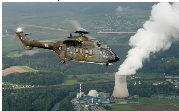
L'elicottero di misurazione durante l'intervento sopra la centrale nucleare di Gösgen
