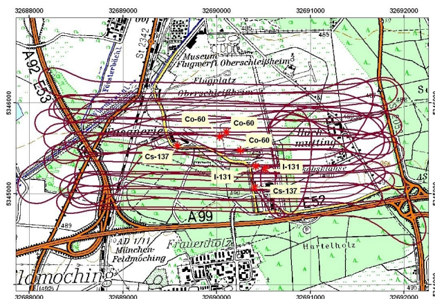
Gauche: carte avec position des sources radioactives cachées (étoiles rouges) et itinéraires de vol (lignes en rouge foncé) parcourus durant les mesures. Droite: carte du débit de dose ambiant (radiation mesurée) le long du parcours exploré. Les pixels jaunes signalent une éventuelle source radioactive.
