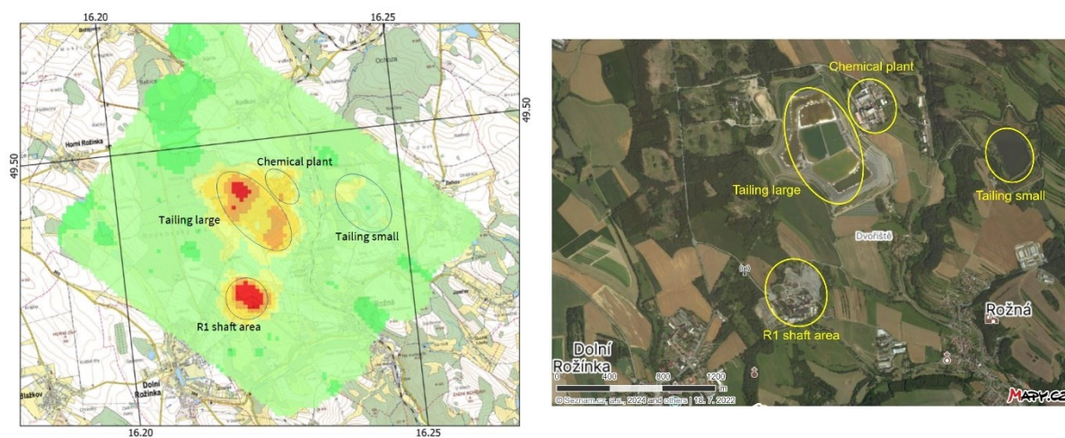
Figure 13 : à gauche : carte du DDA du nord des trois secteurs de la zone de mesure à droite : image satellite de cette région avec les installations de la mine d'uranium de Rožná autour du puits d'extraction, des bassins de décantation (tailings) et de l'installation de traitement chimique ultérieur
