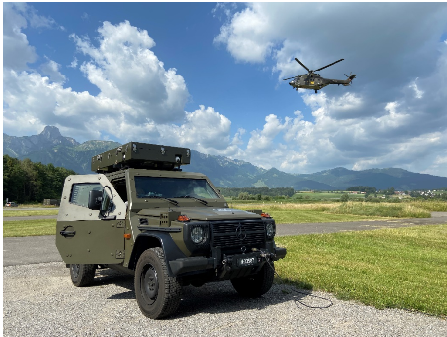
Systèmes de radiométrie au sol et d'aéroradiométrie utilisés simultanément.
