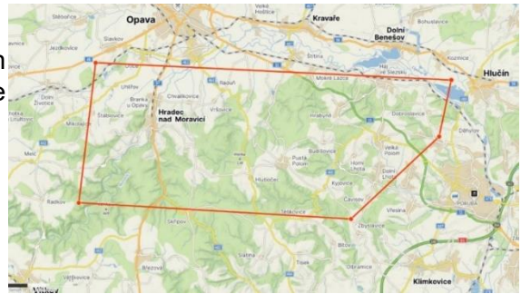
Abbildung 28: Messgebiet Opavsko, das insgesamt ca. 220 km 2 umfasst, durch die teilnehmenden Teams unter sich aufgeteilt und als Composite Mapping-Übung vermessen werden musste. Bildquelle: mapy.cz
