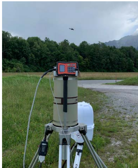
Abbildung 13: In-Situ Gamma Spektrometrie (grau) und Reuter-Stokes-Kammer (weiss); letztere entspricht dem Referenzmessgerät der PSI-Eichstelle
